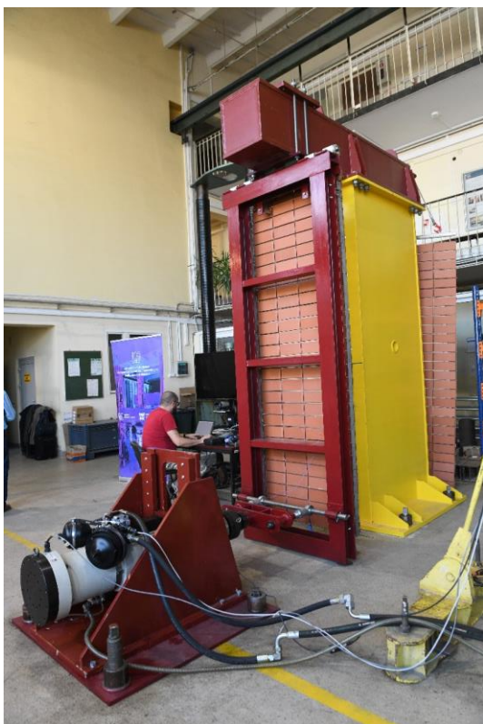
Fot. 1. Stanowisko badawcze kurtyny Flexbrick w L-12 (fot. Jan Zych)
